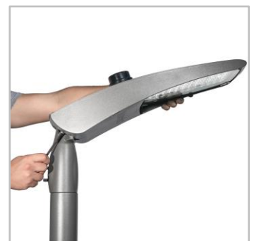
De hellingshoek kan ter plaatse worden aangepast, voor verticale (0 tot +15°) en horizontale (0 tot -15°) configuraties.
