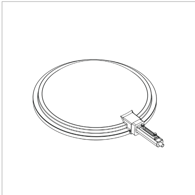
CITEA NG2 | Rotule horizontaal opschuif Ø60mm bevestiging (A6)
