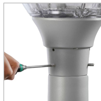
HAPILED biedt een opzetbevestiging op een 60mm diameter mast met 6 M6 schroeven.
