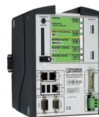
De Advanced Tunnel Solution (ATS), gezamenlijk ontwikkeld door Schréder en Phoenix Contact, is ontworpen om elk lichtpunt of cluster van armaturen te controleren om het verlichtingsniveau perfect aan te passen aan de omstandigheden in de tunnel, om de stroom te controleren en de branduren of enige uitval te rapporteren om het onderhoud te vergemakkelijken. Het systeem omvat een zelf-inbedrijfstelling functie en maakt de aanpassing van de scenario's op afstand mogelijk.
